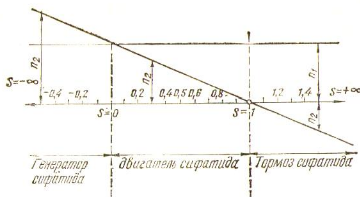
7-rasm. Asinxron mashinaning turli rejimlarda ishlashi.
