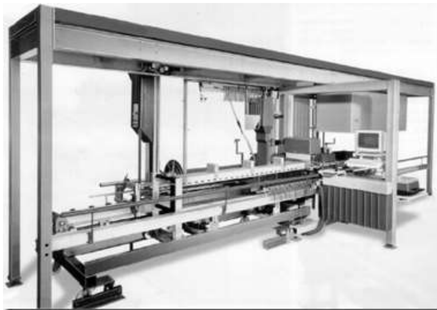
4.1-rasm. Staubli firmasining to'liq avtomatlashtirilgan ip o'tkazish mashinasi
