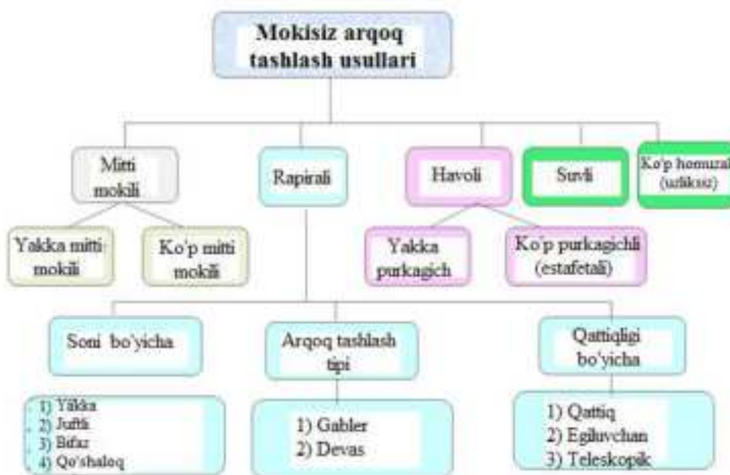
5.10-rasm. Mokisiz arqoq tashlash usullari
