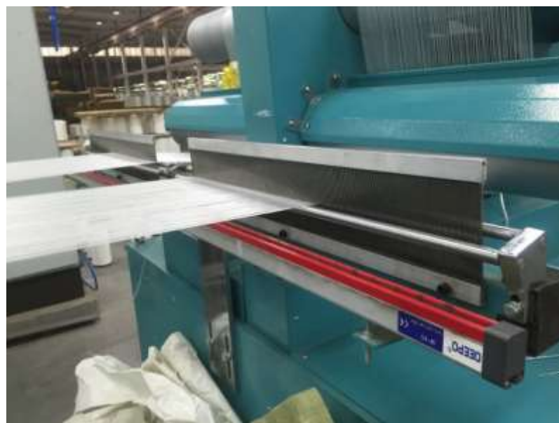
2.16-rasm. LD236T-rusumli Piltalab tandalash mashinasining suport tig'ining joylashishi, rangli iplarni baraban va to'quv g'altagiga tandalanish ko'rinishi.
