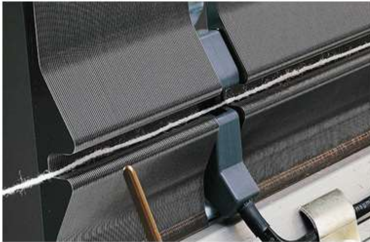
5.19-rasm. Shaklli tig' va purkagich turlari
