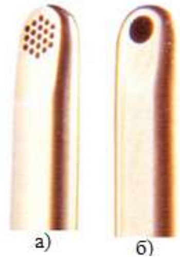
5.19-rasm. Shaklli tig' va purkagich turlari
