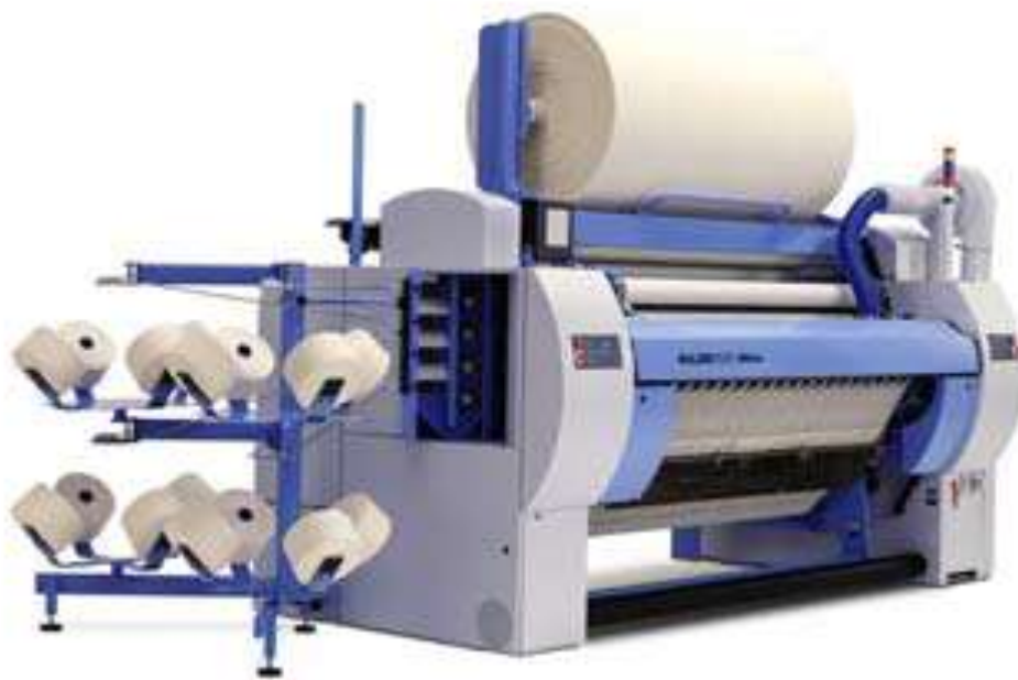
5.31-rasm. Sulzer Ruti M8300 ko'p fazali to'quv dastgohi
