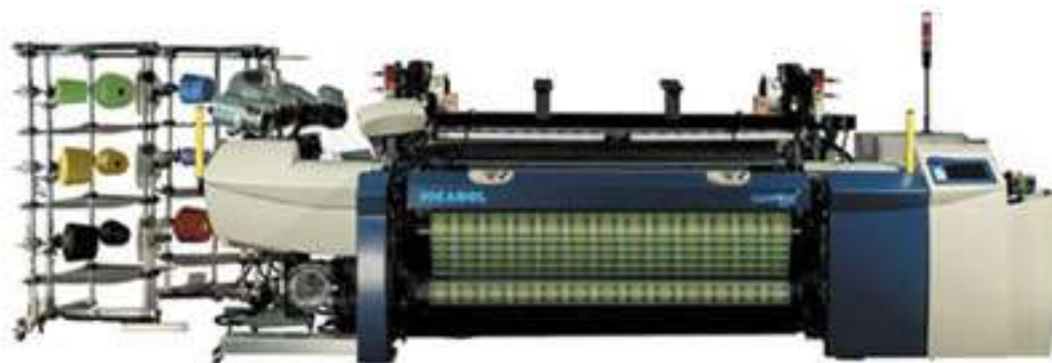
7.1-rasm. Elektron ShKKli Pikapol GamMax (Belgiya) rusumidagi rapirali to'kuv dastgohi
