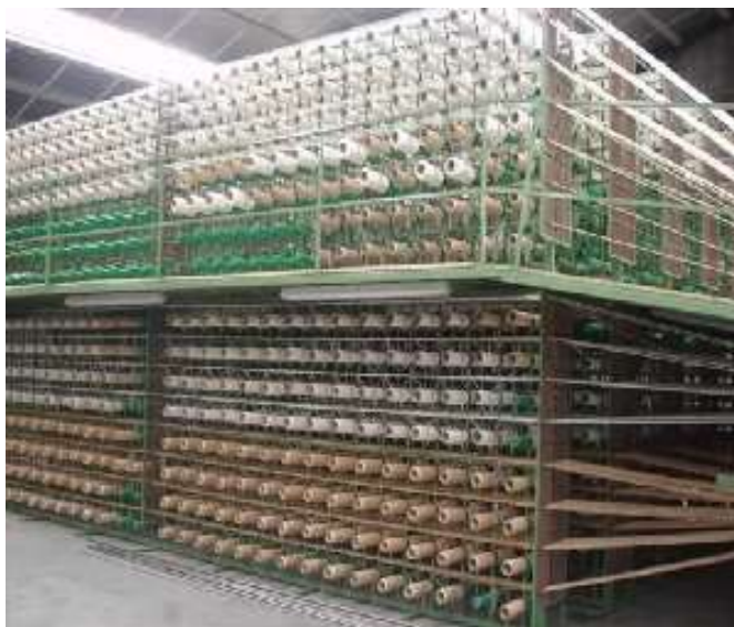
2.10-rasm. Gilam dastgohi uchun maxsus rom
