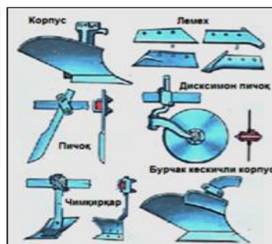
Плугнинг асосий қисмлари ва уларни ростлаш ўлчамлари: 1-рама; 2-чимқарқар; 3-дискли пичок; 4-асосий ағдаргич (корпус)
