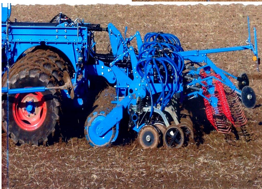
1.33-rasm. LEMKEN. Compakt-Solitair-9K rusumidagi kombinatsiyalashgan seyalkasi.
