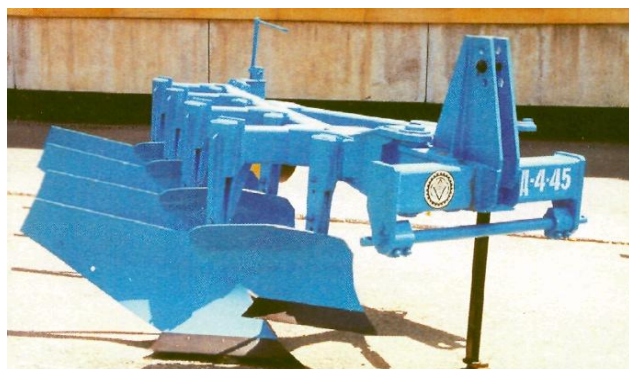
1.13-rasm. PD-4-45 ikki yarusli to'rt korpusli osma plug, sho'rlanmagan toshsiz yerlarni 40 sm gacha chukurlikda haydashga mo'ljallangan
