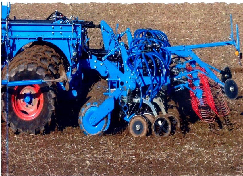
1.33-rasm. LEMKEN. Compakt-Solitair-9K rusumidagi kombinatsiyalashgan seyalkasi.
