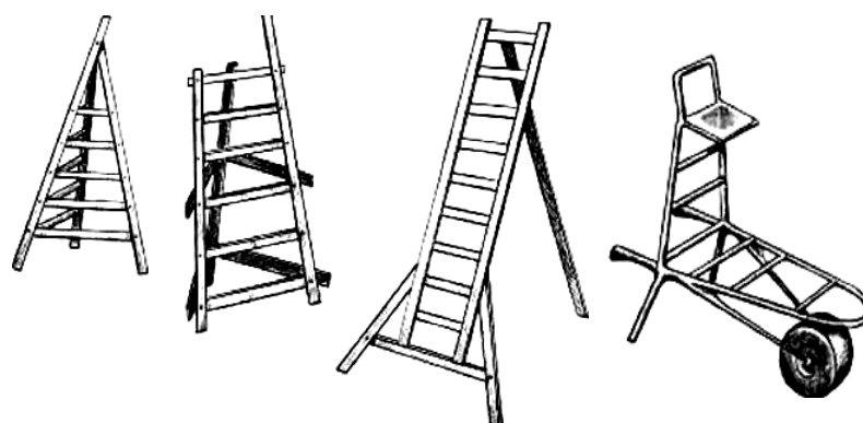
Mevalarni terib olishda foydalaniladigan narvon (a) va savat (b) turlari
