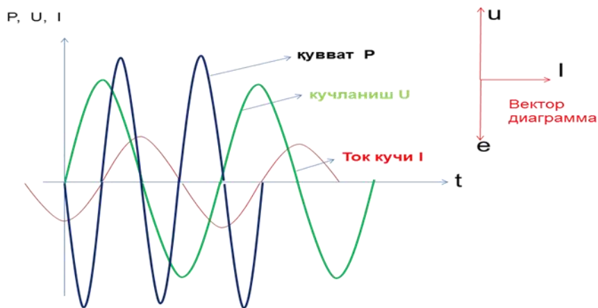
4.7-rasm. Induktiv elementli zanjirda kuchlanish, tok kuchi va quvvatning diagrammalari (a) va zanjirning vektor diagrammasi (b)
