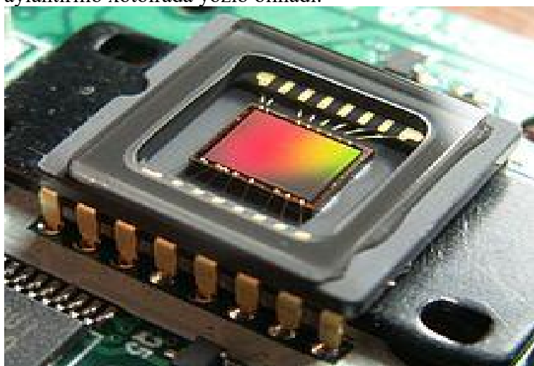
17.2-rasm. Tasvirni elektron shaklga o'tkazib beruvchi matritsa PZS.
