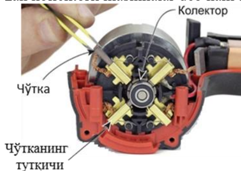
11.5-rasm. Kollektor va cho'tkaning mashinada joylashgan holati.
