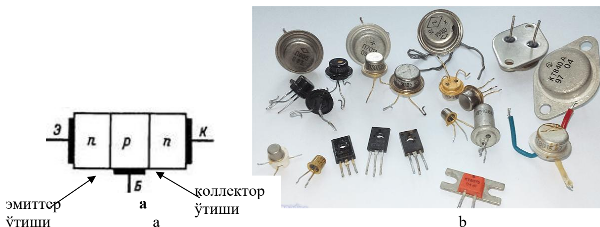
14. 14-rasm. Tranzistorning shartli belgisi, tuzilishi (a) va amalda keng tarqalgan tranzistorlardan ayrimlarining umumiy ko'rinishi (b).
