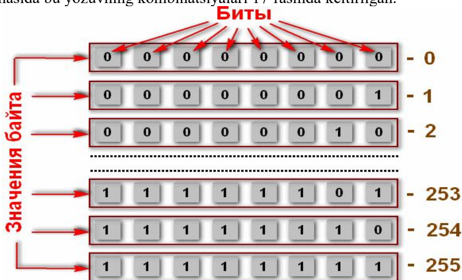
16.17- rasm. Ma'lumotlarni ikkilik sanoq sistemasida ifodalash va xotira hajmining hosil bo'lishi.
