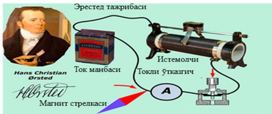
1.6-rasm. Ersted tajribasida tokli o'tkazgichning magnit strelkasiga ta'siri.
