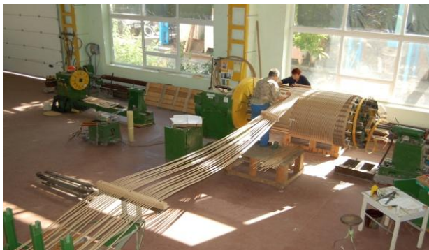
9.11- rasm. CHulg'am simlarini izolyatsiyalovchi lentalar bilan o'rash
