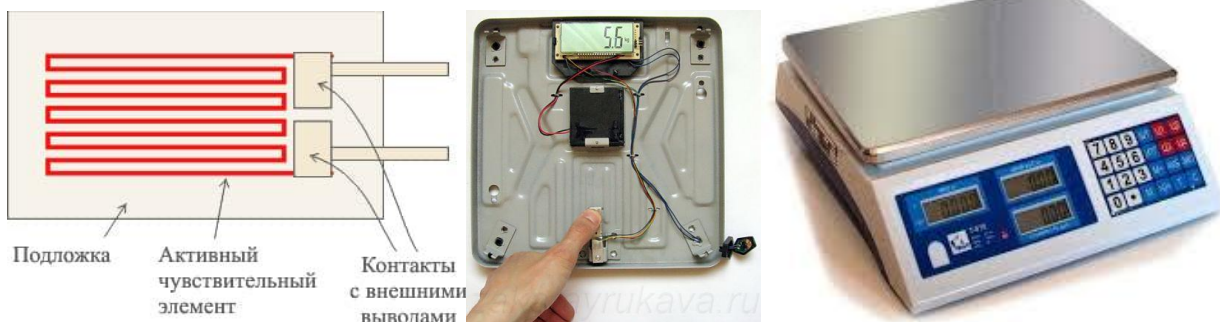
8.12-rasm. Tenzoelektrik effektga asosida ishlovchi tarozilar
