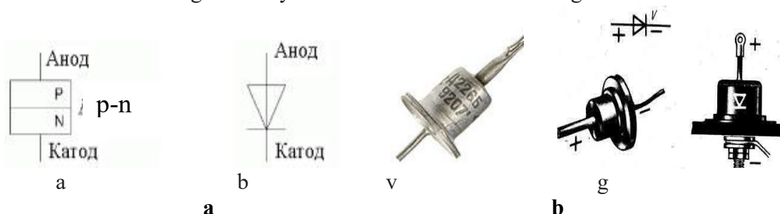
14.10- rasm. Yarim o'tkazgichli diodning strukturasi (a), shartli belgisi (b), D226B diodining umumiy ko'rinishi (v) va diodlarda qutblarning belgilanishi.
