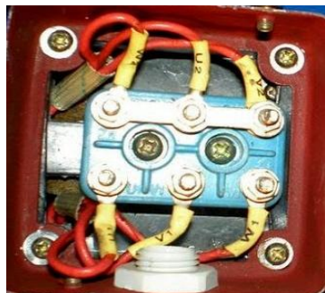
10.15 –rasm. CHulg'amlari yulduz (a) va uchburchak (b) sxemada ulangan asinxron dvigatel kontaktlar qutisi
