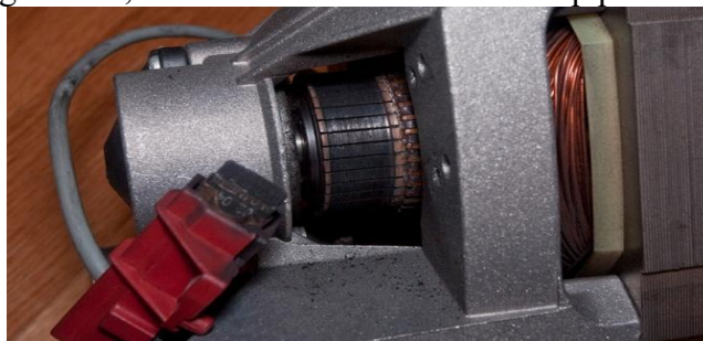
11.7- rasm. O'zgarmas tok mashinasi kollektor-cho'tka qismi va cho'tka.
