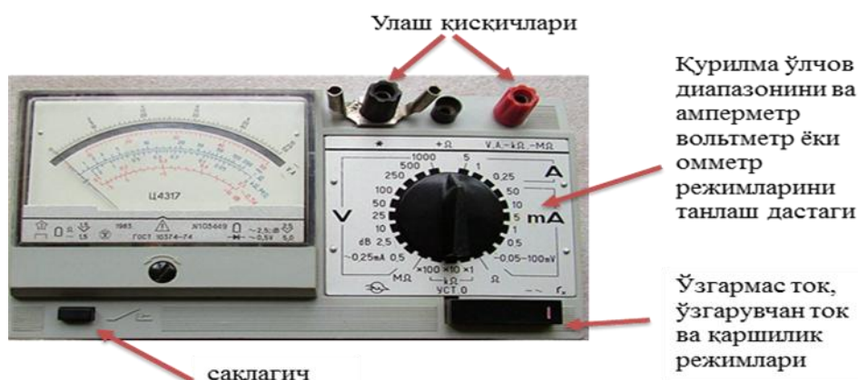
7. 7- rasm. Amalda eng ko'p iste'molda bo'lgan TS4317 markali universal elektr o'lchov qurilmasi.
