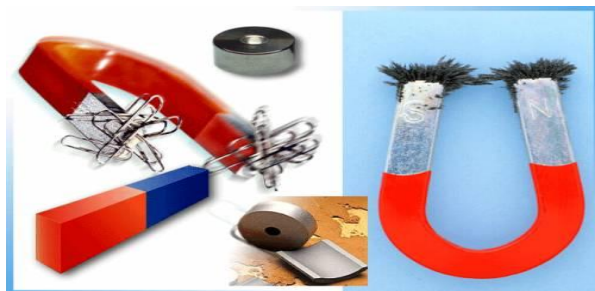
6.11-rasm. Doimiy magnitlar va uning maydoni.
