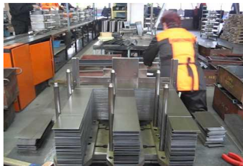
9.6-rasm. Transformator o'zagi yaproqchalari va ularni tayyorlash jarayoni:
