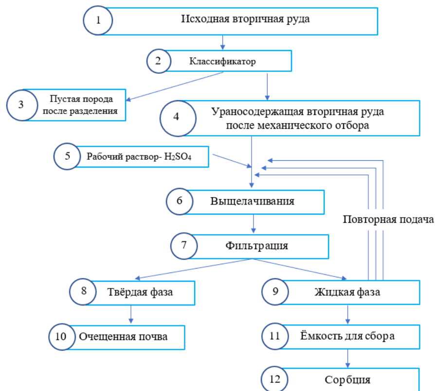
Рис. 5. Принципиальная физико-химическая геотехнологическая схема извлечения урана из ураносодержащих вторичных техногенных руд
