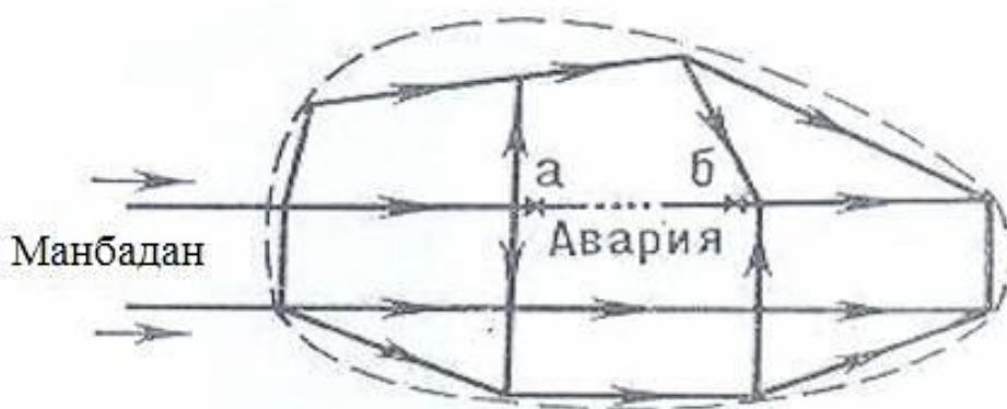
3.4-rasm. Halqa suv tarmog'ining sxemasi.
