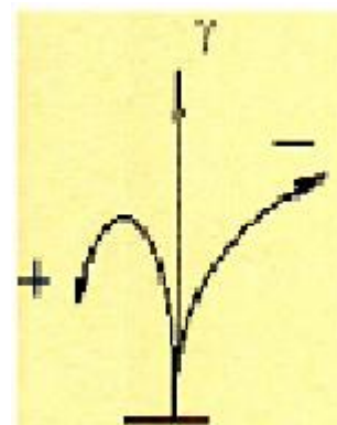
Рис. 10. Схема разделения частиц солнечного вещества (плазмы).
