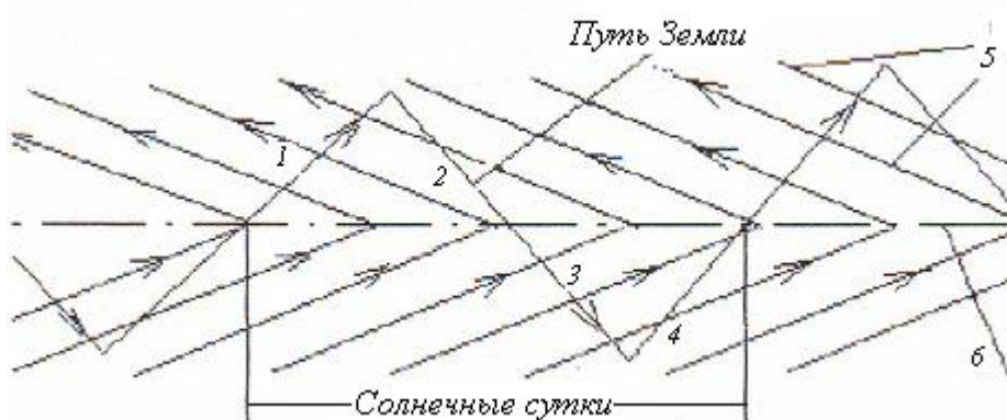
Рис. 14. Схема смены полярности межпланетного поля относительно Земли. 1,2,3,4 – зоны разнонаправленности магнитного поля,
