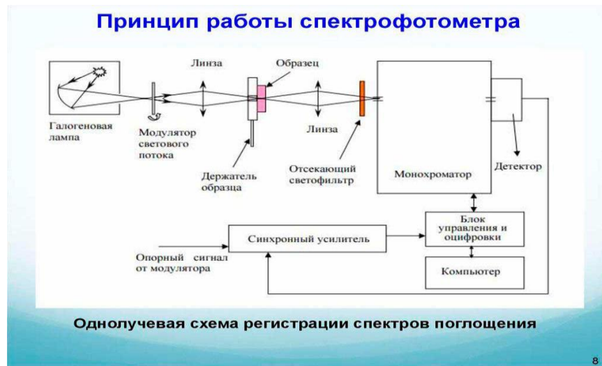
Рис.11.2. Принцип работы спектрофотометра.
