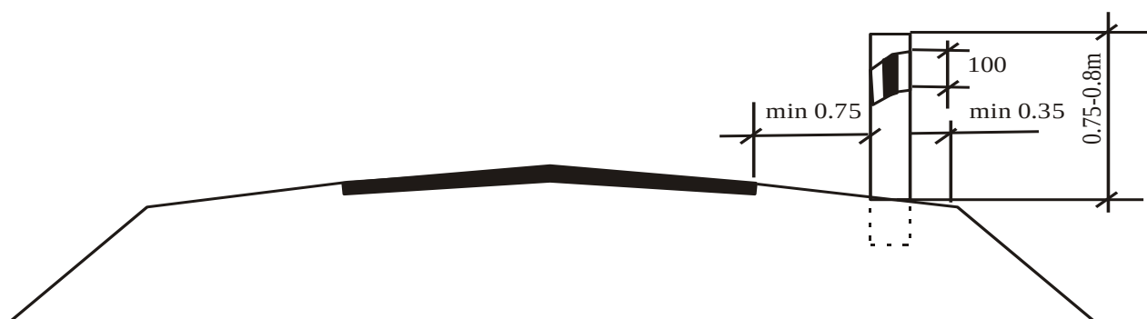
7.14-rasm. Yo'naltiruvchi ustunchalarni yo'lning ko'ndalang kesimida o'rnatish.
