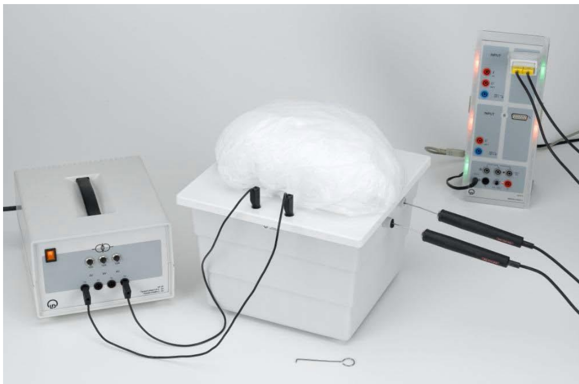
1-rasm. Yakka plastina metodidan foydalanib, qurilish materiali namunasining issiqlik o'tkazuvchanligini aniqlash uchun qurilma.
