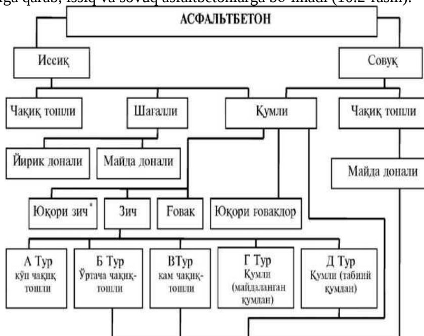
10.2-rasm. GOST 9128 bo'yicha asfaltbetonning tasniflanishi
