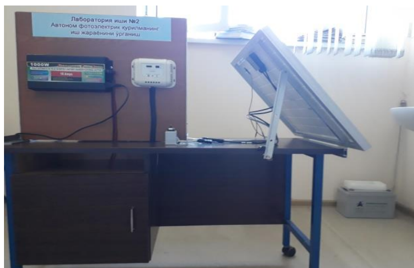
10- rasm. Avtonom quyosh fotoelektrik qurilmasi o'rnatilgan laboratoriya stendi
