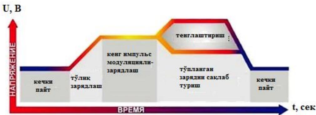
6-rasm. Quyosh panelidan akkumulyatorni zaryadlashdagi bosqichlar
