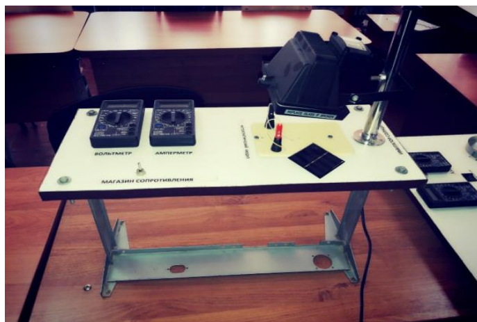
1.Rasm. QE ning voltamper xarakteristikasini o‘rganish uchun eksperimental qurilma
