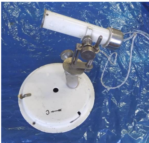
1-rasm a) Aktinometr AT-50
