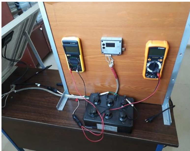
2-Rasm. Fotoelektrik batareyaning volt-amper va volt-vatt xarakteristikasini olish stendi.
