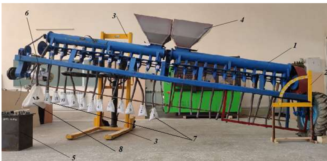
1-seyalkaning laboriya qurilmasi; 2-transportir; 3-gidromexanik tal; 4-bunker; 5-reostat; 6-elektrodvigatel; 7-qoplar; 8-qo‘shimcha qop 7-rasm. Taklif etilgan seyalka laboriya qurilmasining engashgan holatdagi ko‘rinishi
