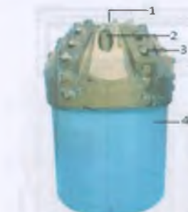
Рис. 2. Шестилопастная конусная бурильная головка типа 6ЛБК-МСЗ 1-керноприемные отверстие, 2-каналы для промывочные жидкости, 3-резец твердосплавные 4-Корпус бурильная головка
