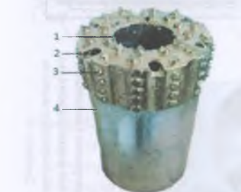
Рис. 4. Цилиндрическая бурильная головка 1-Керноприемные отверстие, 2-каналы для промывочные жидкости, 3-резец твердосплавные, 4-Корпус бурильная головка
