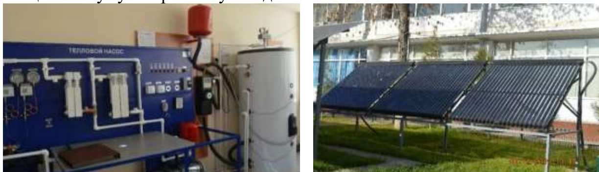
6- расм. Қуёш энергияси ҳосил қиладиган иссиқликдан фойдаланадиган лаборатория иссиқлик насоси элементлари
