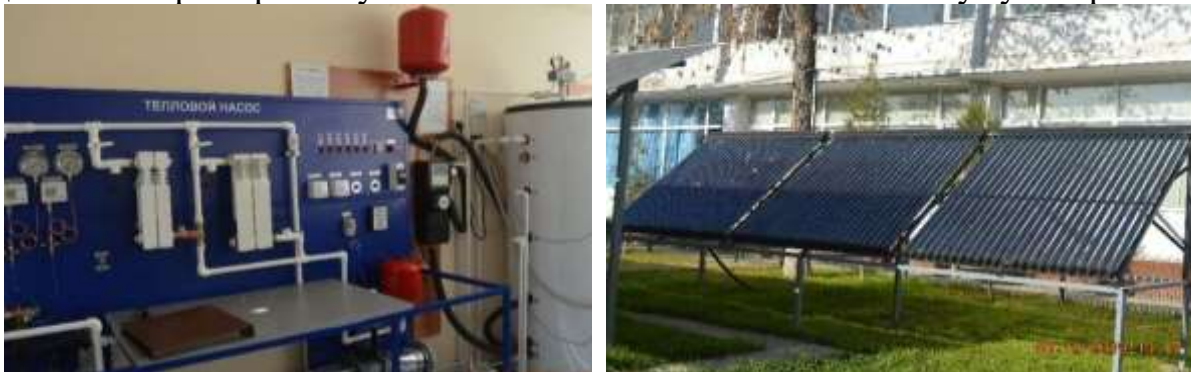
Рис. 6. Элементы лабораторной теплонасосной установки с использованием тепла, вырабатываемого от солнечной энергии
