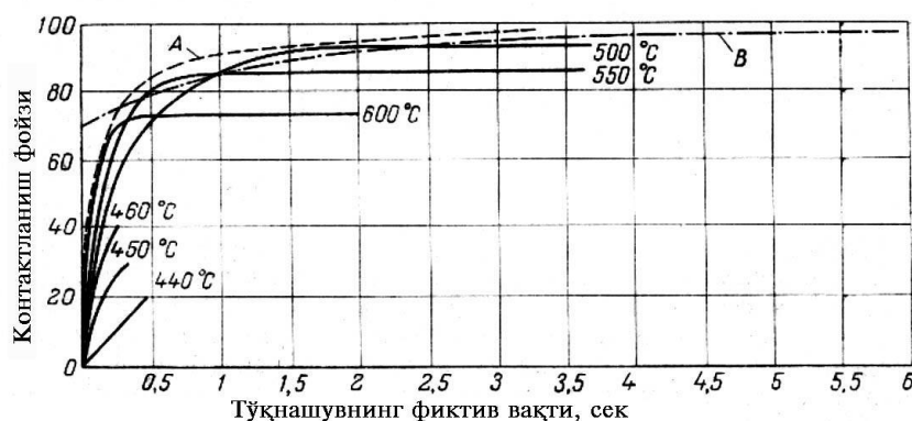
19-расм. Турлича хароратлардаги ванадийли катализаторларда \text{SO}_2 нинг оксидланишида контактланиш даражасининг тўқнашувлар вақтига боғлиқлиги (газ таркибида 7% \text{SO}_2 ва 11% \text{O}_2 бор)
