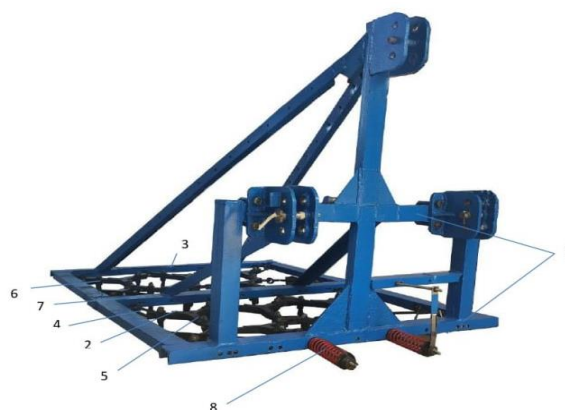
1-рама; 2, 3-передний и задний ряд рабочих звеньев; 4-кольца; 5-тяги; 6-зубья; 7-поперечная балка; 8-пружина сжатия
