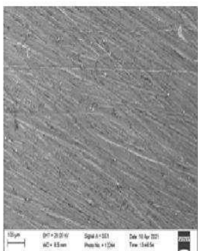
Рис. 7. Исходное состояние поверхности стали St20, полученное с помощью сканирующего электронного микроскопа.
