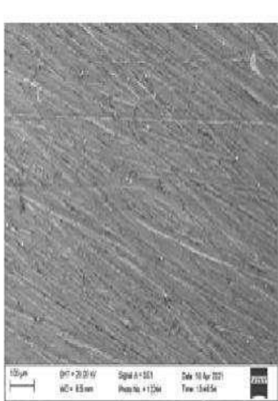
7-rasm. Skanerlovchi elektromikroskop yordamida olingan po‘lat St20 sirtining dastlabki holati.
