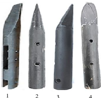
1 - коническое; 2-традиционное; 3-игольчатое; 4- усеченное цилиндрическое долото
