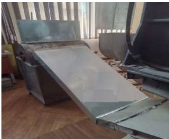
Рис. 4. Лабораторный стенд очистителя волокна марки 1ВПУ
