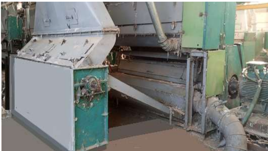
7-rasm. Yangi konstruksiyaga ega arra konstruksiyasini oʻrnatilgan tola tozalash uskunasiining umumiy koʻrinishi
