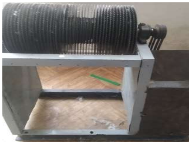
Рис. 4. Лабораторный стенд очистителя волокна марки 1ВПУ
