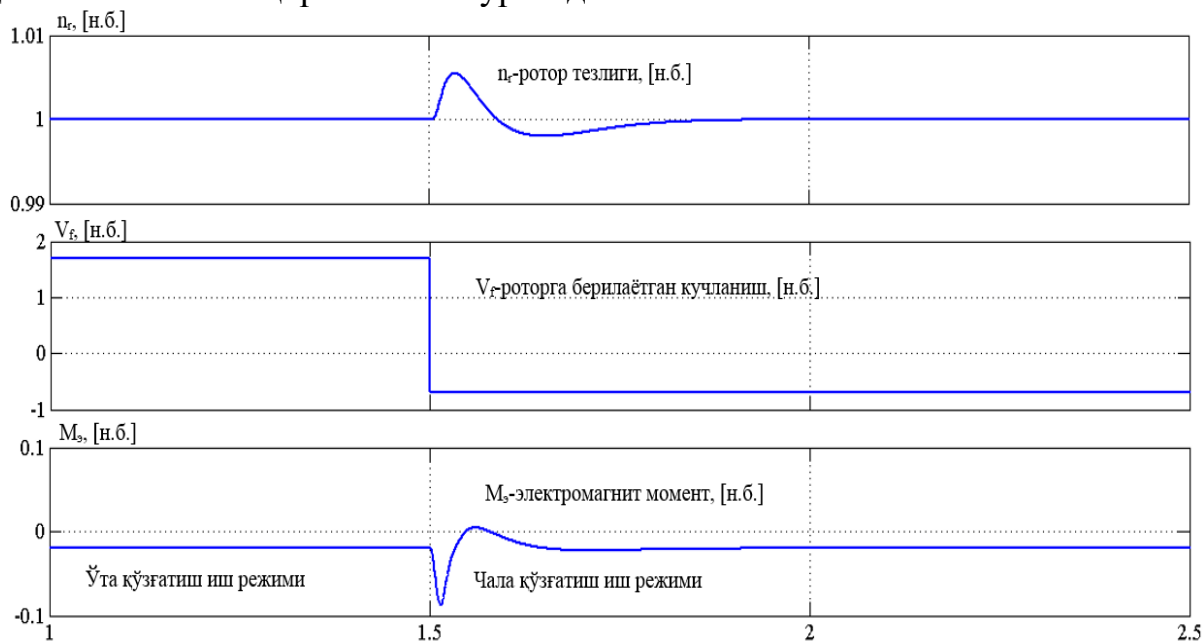
11-расм. Икки ўқи бўйича қўзғатиладиган синхрон компенсаторнинг ўта қўзғатиш режимидан чала қўзғатиш режимга ўтгандаги (қўзғатиш токининг манфий қийматида) ротор тезлиги ва электромагнит моментнинг ўзгариши графиклари
