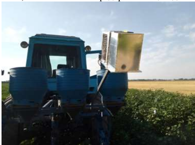
9-расм. Вўза агробιοοценозида учрайдиган “Noctuidae” оиласи вакиллариға қарши тракторға ўрнатилган трихограммани тарқатиш қурилмасининг трихограммани тарқатиш жараёни (Тошкент вилояти, Ёўқа тумани, “Темур” ф/х, 2021-2024 йй.)
