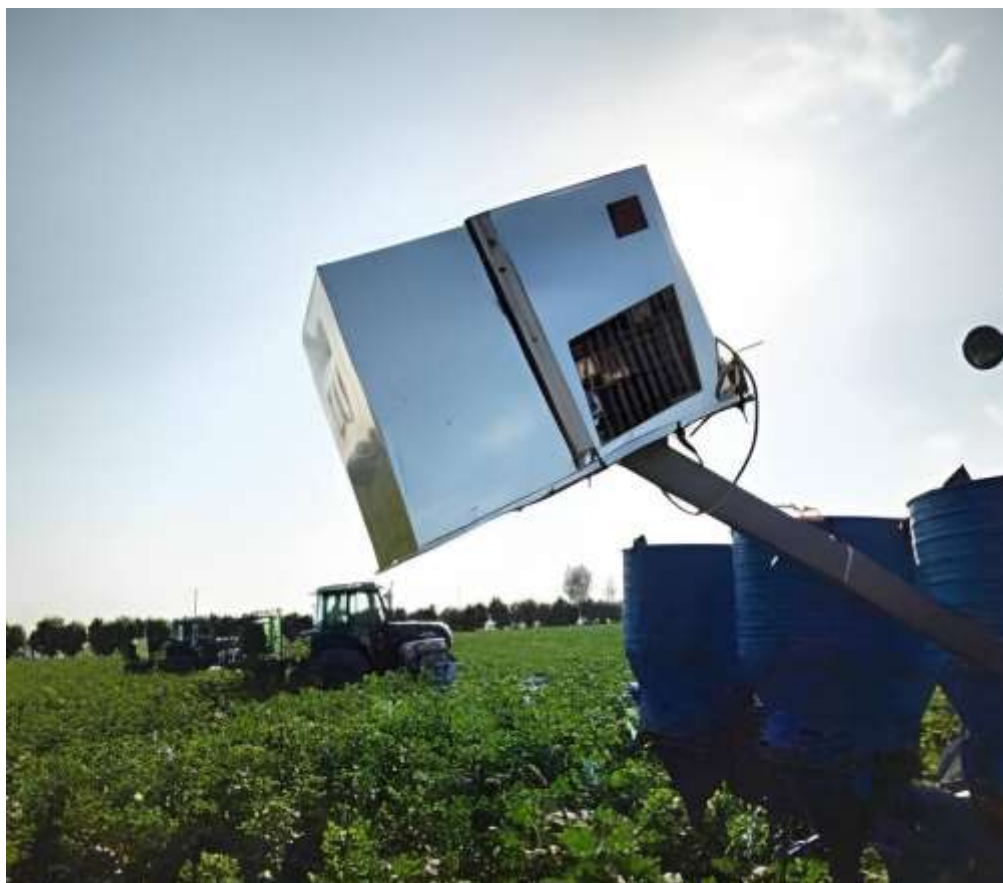
Трактор ёрдамида трихограммани тарқатиш қурилмасида трихограмма авлодларини тарқатиш жараёни (Тошкент вилояти)
