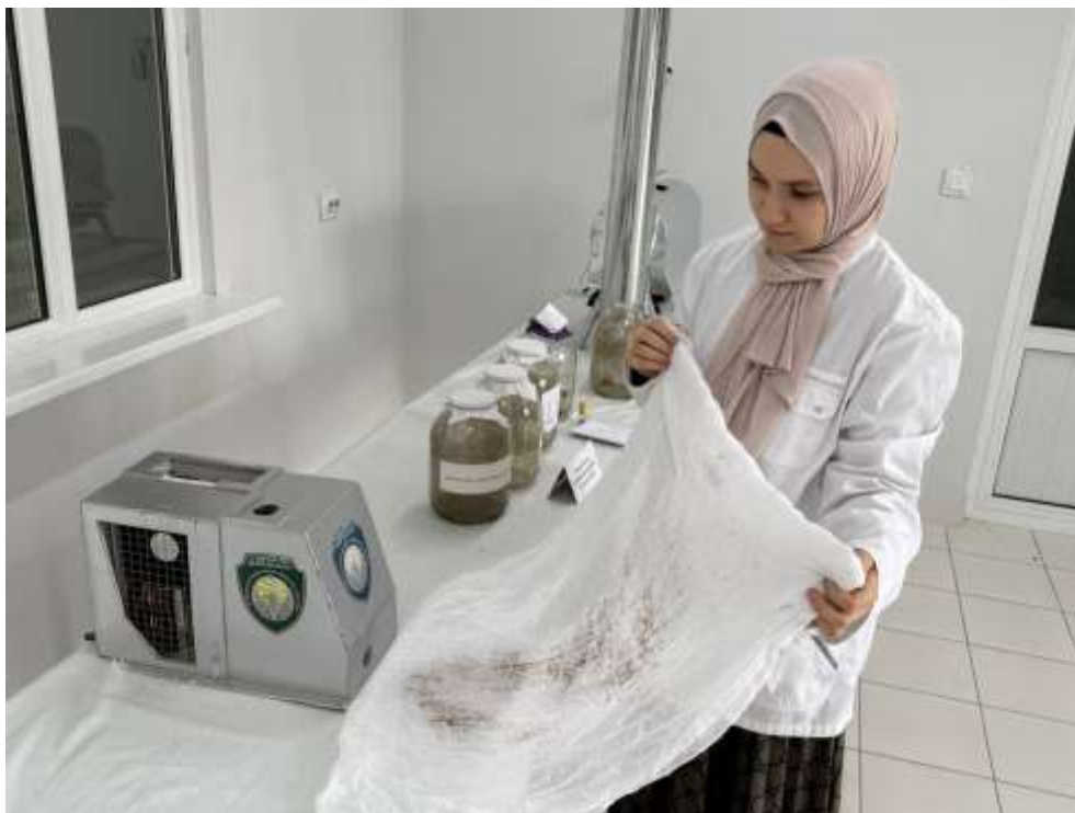
4-расм. Трактор ёрдамида механизациялашган усулда трихограмма турларини тарқатиш қурилмасини дастлабки лаборатория синовидан ўтказиш (2023-2024 йиллар).
