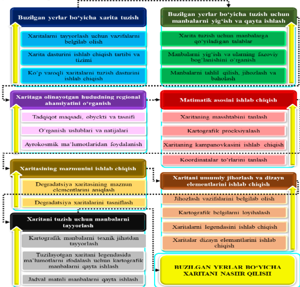
4-rasm. Buzilgan yer maydonlarining xartasini kameral sharoitda ishlab chiqish bo'yicha metodologik bosqichlar
