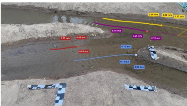
Рис. 13. Кинематическая характеристика взвешенных и донных наносов на физической модели при v_{\text{бел}} = 0,60 \frac{\text{м}}{\text{с}}
