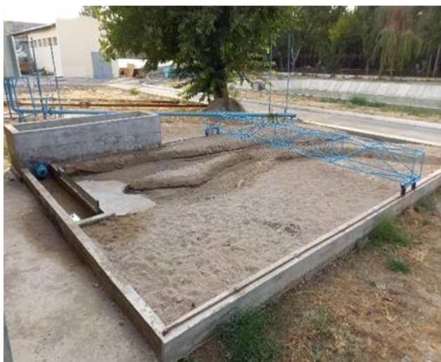
Рис. 2. Физическая модель и расположение выбранных створов
