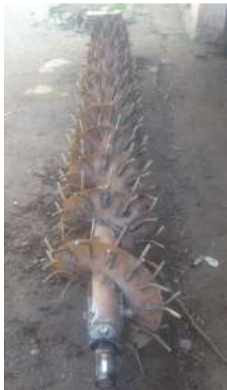
Рисунок 12. Общий вид колкового шнека усовершенствованного шнекового очистителя
