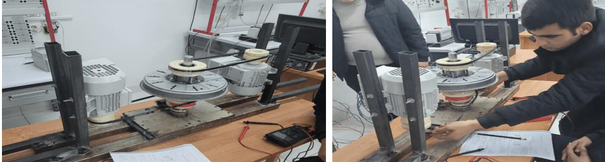
Рис. 15. Процесс экспериментов, проведенных на генераторе с радиальной осью, вращающимся с противоположным вращением ротора и статора.
