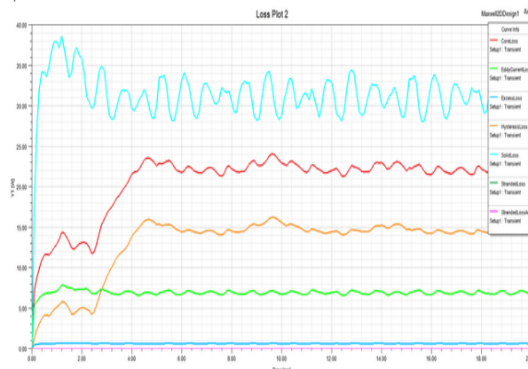
Рис. 10. Потери в двухроторном электрогенераторе со статором из твердой резины
