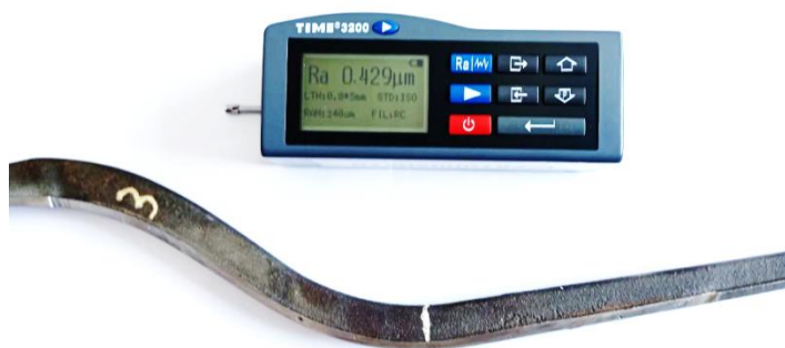
Рис. 12. Прибор для измерения шероховатости поверхностей колосников (параметры R_a и R_z )
