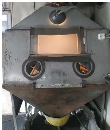
15-rasm. Cho‘yan kolosniklarni mikrosharchavlar bilan zarbali ishlov berish qum sochuvchi apparat
