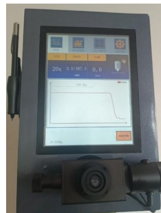
11-rasm. “Yuklash-vaqt” diagrammasini avtomatik yozish bilan yuklash (o‘lchash) tugashining registratsiyasi
