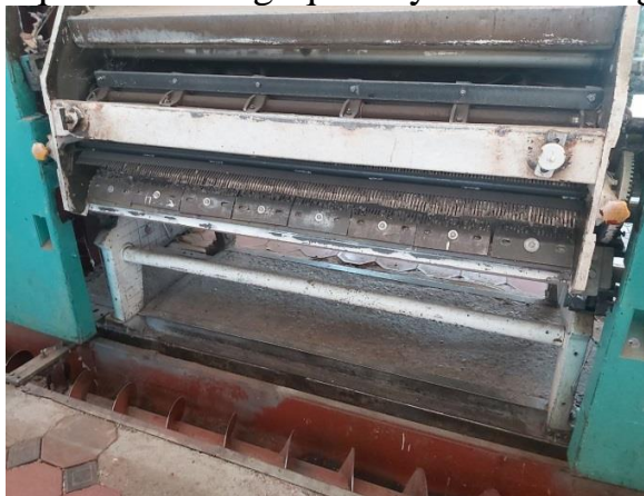
13-rasm. Chidamlilikni sinash uchun nazorat kolosniklari bilan 5LP linteri
