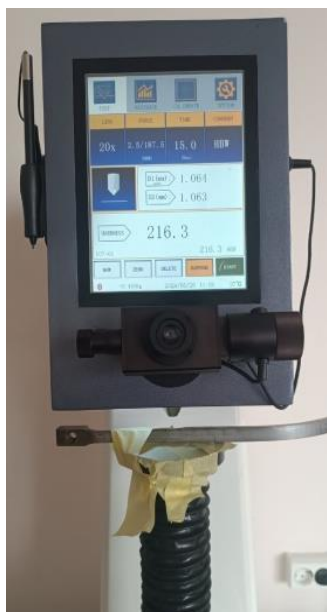
Рис. 9. Измерительно-регистрирующий блок прибора-твердомера HRS-300E
