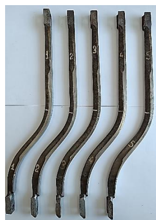
Рис. 14. Контрольные колосники джина для испытания на износостойкость
