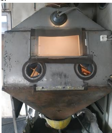
Рис. 15. Пескоструйный аппарат для дробеударной обработки микрошариками чугуных колосников
