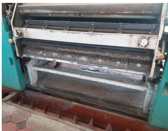
Рис. 13. Линтер 5ЛП с контрольными колосниками для испытаний на износостойкость
