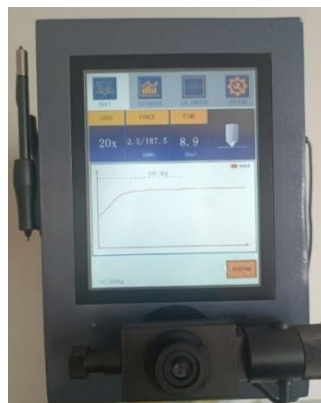
10-rasm. “Yuklash-vaqt” diagrammasini avtomatik yozish bilan yuklash (o‘lchash) boshlanishini registratsiyasi
