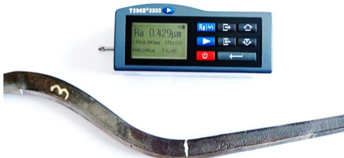
12-rasm. Kolosniklar yuzasining notekisligini o‘lchash pribori ( R_a va R_z parametrlari)
