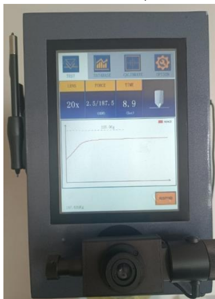
Рис. 10. Регистрация начала нагружения (измерения) с автоматической записью диаграммы “нагрузка-время”
