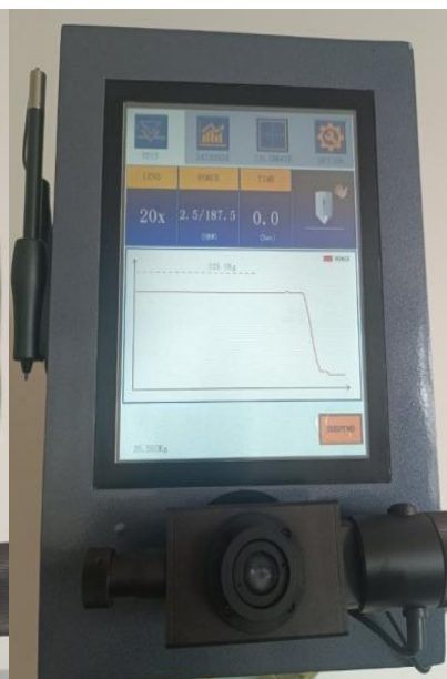
Рис. 11. Регистрация окончания нагружения (измерения) с автоматической записью диаграммы “нагрузка-время”
