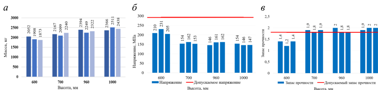
Рис. 1. Зависимости основных параметров вагона-платформы от высоты поперечного сечения балок: а – массы тары; б – эквивалентных напряжений; в – запаса прочности
