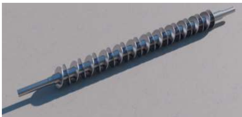
21-rasm. Arrali jin mashinasiga o'rnatilgan tezlatkich-surgich
