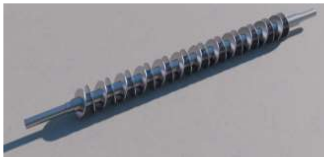
Рис. 21. Ускоритель-направитель установленный на пильного джине
