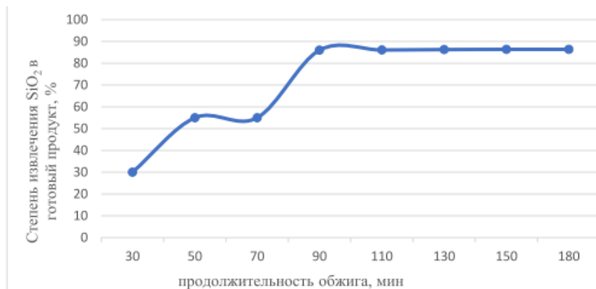
Рисунок 2. Зависимость степени извлечения SiO 2 из хвостов медно-обогатительной фабрики при оптимальных температурах от продолжительности обжига
