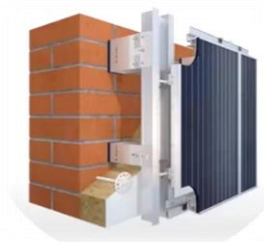
4-rasm. Shamollatiluvchi fasadda quyosh panelining o'rnatilishi sxemasi.
