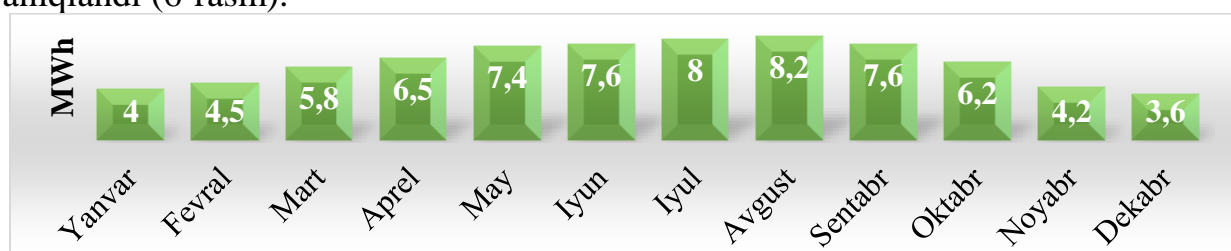
6-rasm. Quyosh paneli tomonidan umumiy ishlab chiqarilgan o'rtacha ~ 41° da elektr energiya
