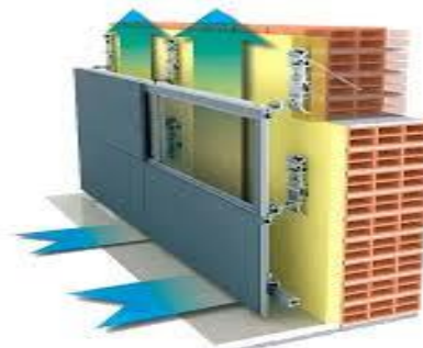
Рисунок 4. Схема установки солнечных панелей на вентилируемом фасаде.
