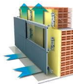
4-rasm. Shamollatiluvchi fasadda quyosh panelining o'rnatilishi sxemasi.
