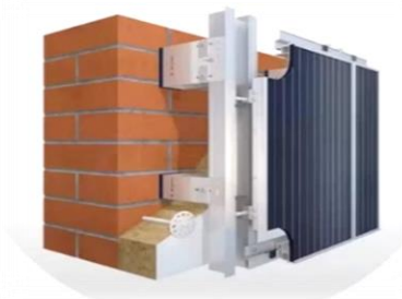
Рисунок 4. Схема установки солнечных панелей на вентилируемом фасаде.
