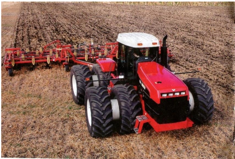
9-rasm. VERSATILE rusumidagi tuproqqa ishlov beruvchi universal chizel-kultivatori. Ushbu agregat ekinlardan bo'shagan yerlarda, shuningdek ang'iz dalalarni 25-30 sm yumshatishga mo'ljallangan.
