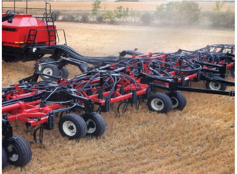
8-rasm. VERSATILE DH-730 rusumidagi qishloq xo'jaligi ekinlarini ekishga mo'ljallangan pnevmatik seyalka. Ushbu seyalka 3; 5 sektsiyali, 8,5 dan 12,2 metrgacha qamrov kengligida ekishga mo'ljallangan.
