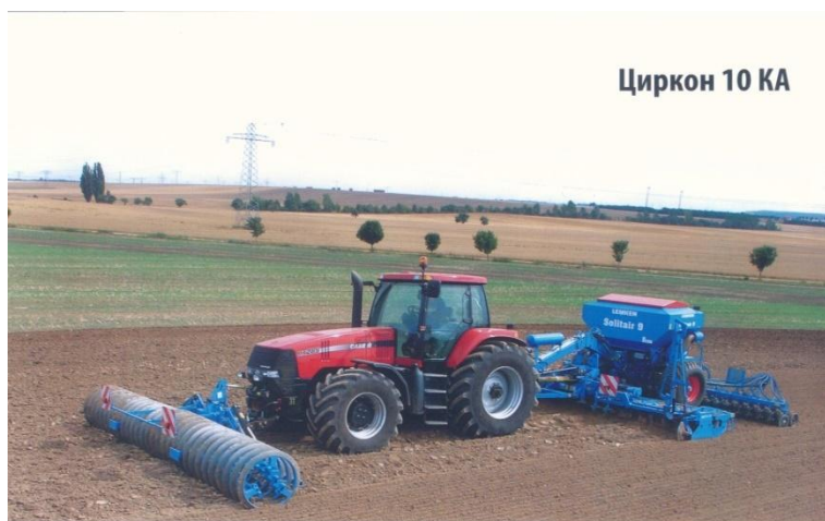
12-rasm. LEMKEN kompaniyasining Zirkon 10KA rusumidagi rotatsion borana hamda Solitair-9K rusumidagi kombinatsiyalashgan seyalkasi.
