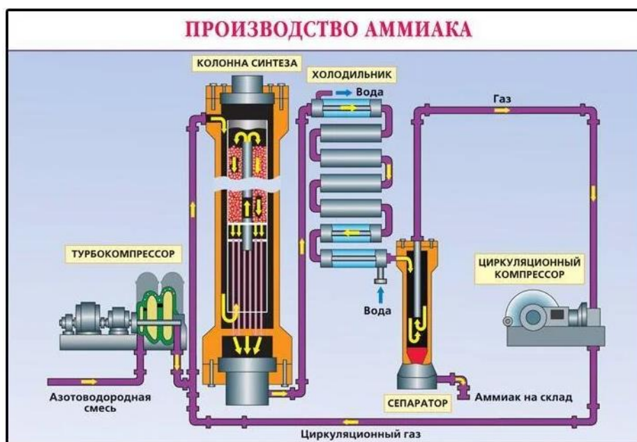
Рисунок 1. Технологическая схема производства аммиака
