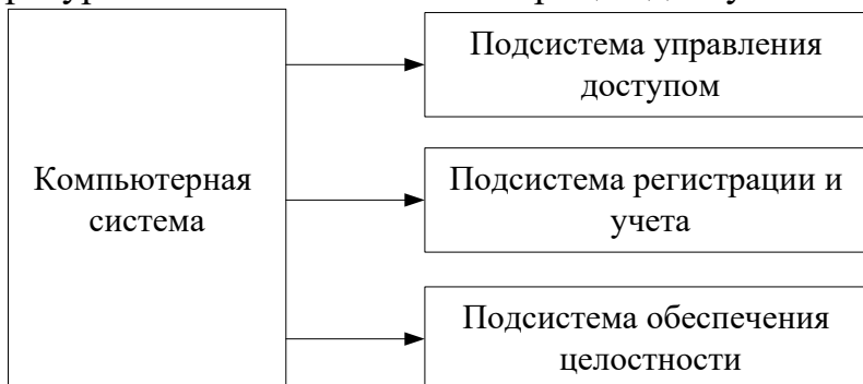
Рис. 1. Подсистемы обеспечения защиты информации в компьютерных системах
