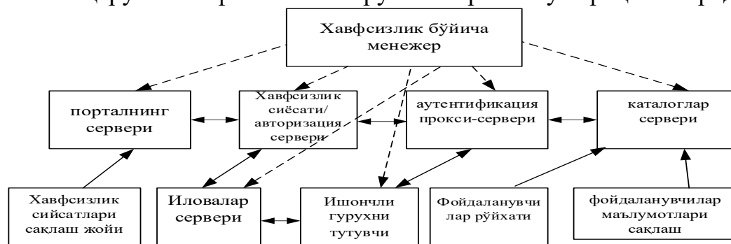
1-расм. Масофавий ўқитиш портали хавфсизлиги қисмтизимиининг архитектураси
