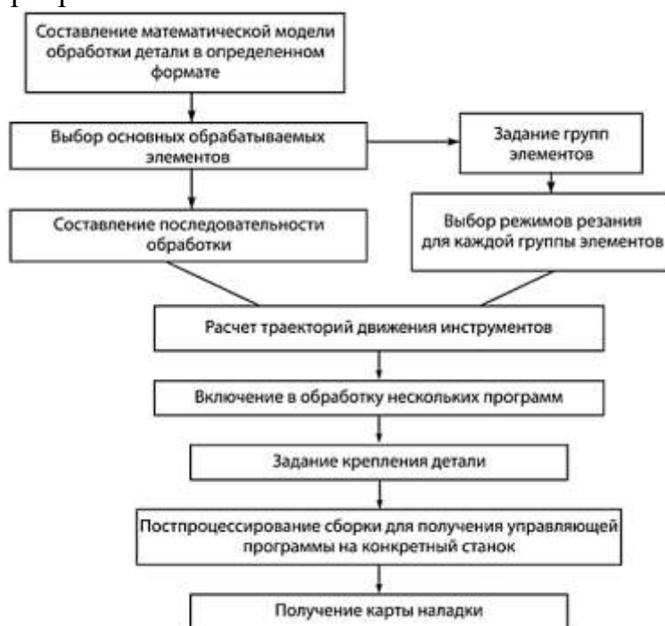
Рис.1. Этапы разработки управляющей программы для станков с ЧПУ
