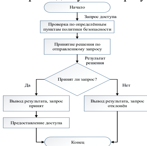
Рисунок 4. Блок-схема алгоритма принятия решений и его реализации при управлении доступом
