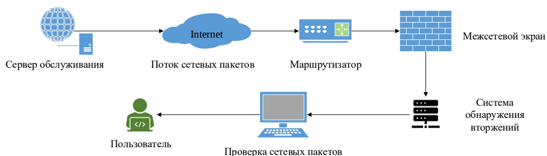
Рисунок 1. Архитектура сети с системами обнаружения вторжений
