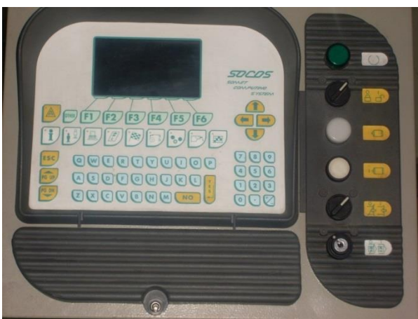
8.5-rasm. Somet dastgohining kompyuter tizimining umumiy ko'rinishi.
