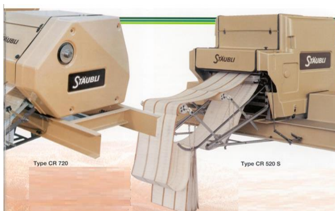
7.11-rasm. Ikki ko'tarimli, bir tsilindrli jakkard mashinasini ko'rinishi
