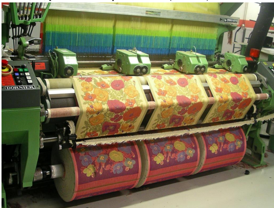
7.1-rasm. Jakkard mashinasida xomuza va naqsh hosil qilish.
