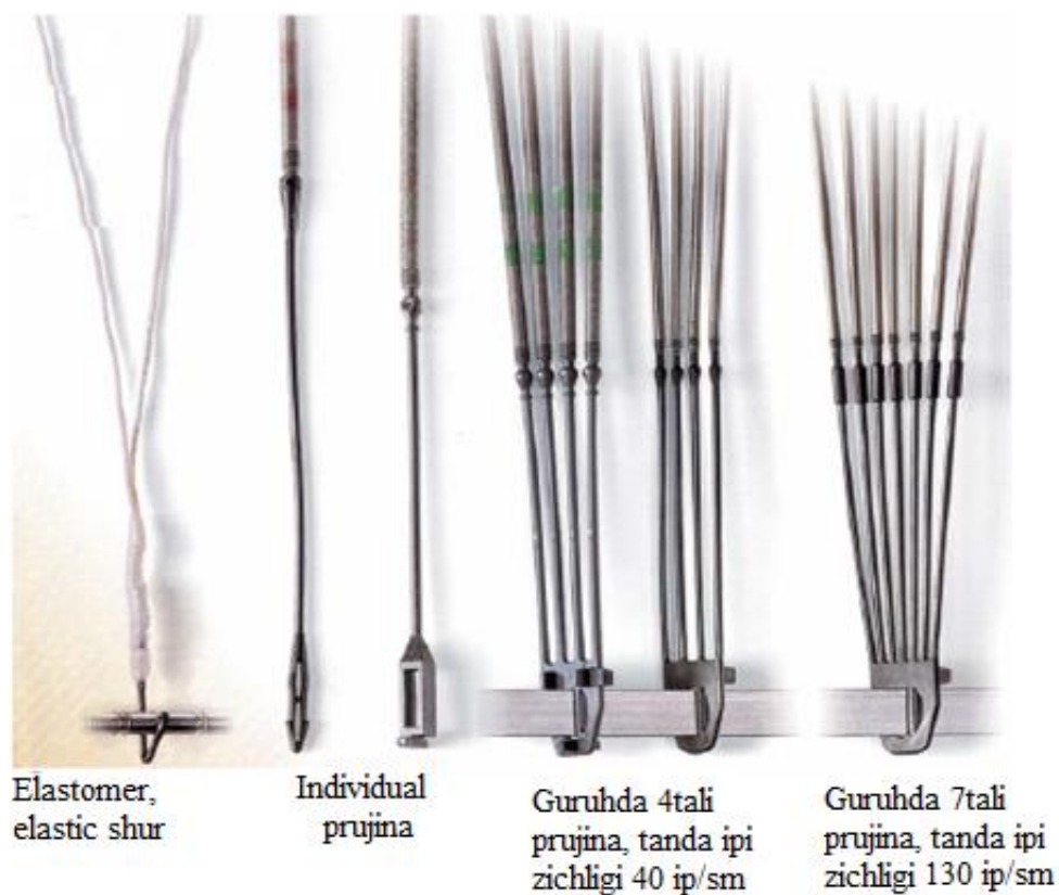
7.18-rasm. Tanda iplarini pastga tushirish elementlari
