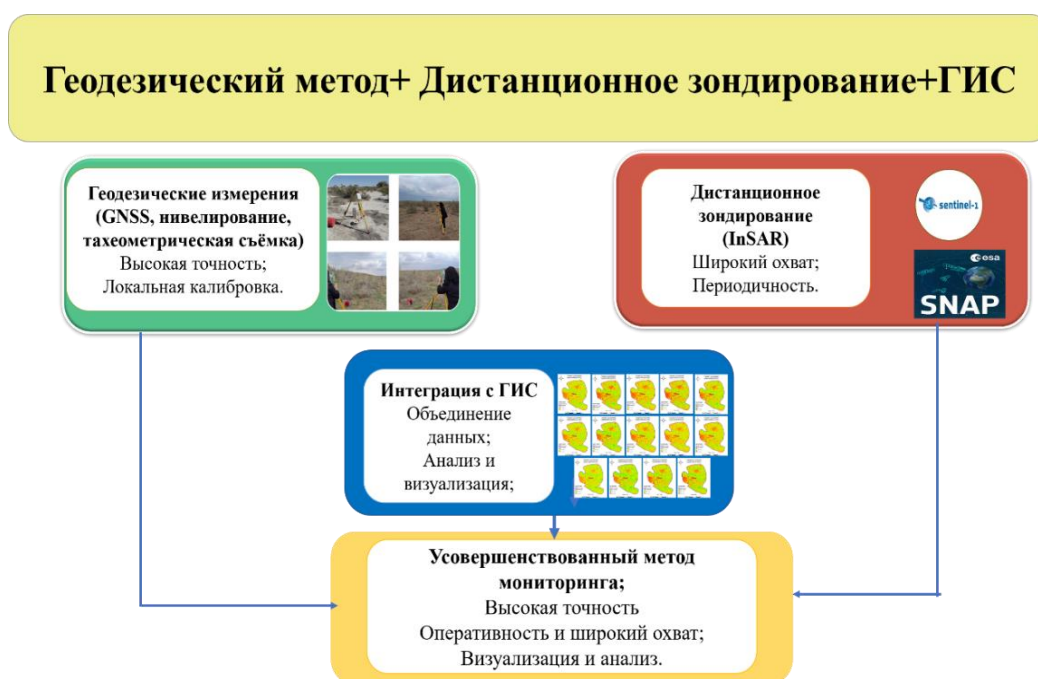
Рис. 3. Усовершенствованный метод мониторинга деформационных изменений, происходящих на поверхности земли
