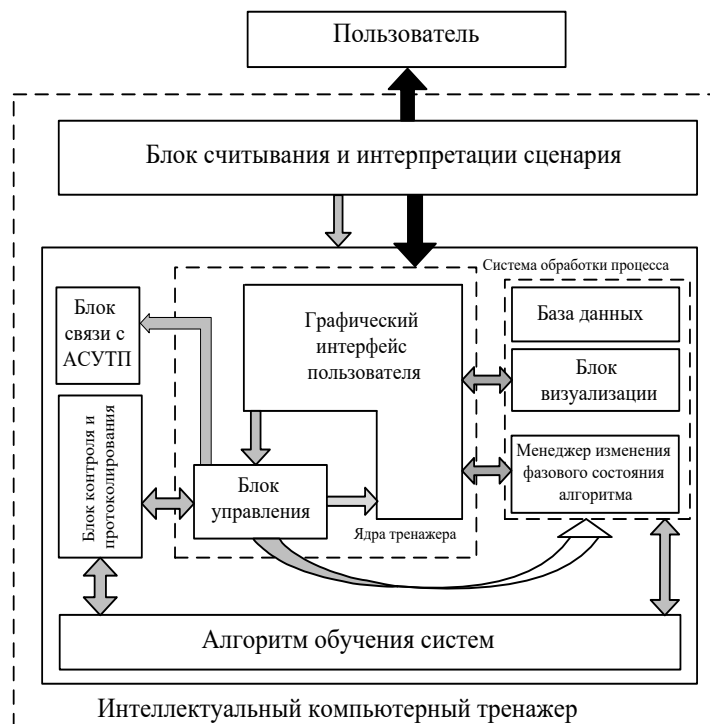
Рис. 9. Структурная схема системы обучения с интеллектуальным компьютерным тренажёром
