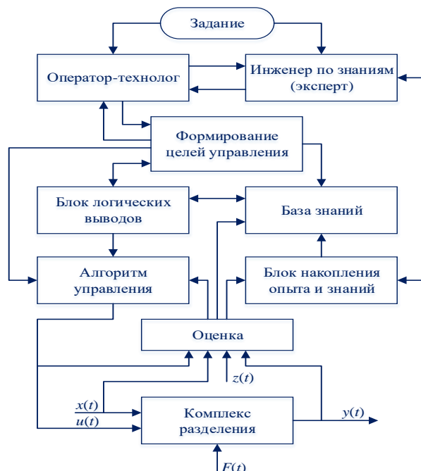
Рис. 3. Структура предлагаемой интеллектуальной системы управления для управления разделительными комплексами, оснащенными множеством устройств
