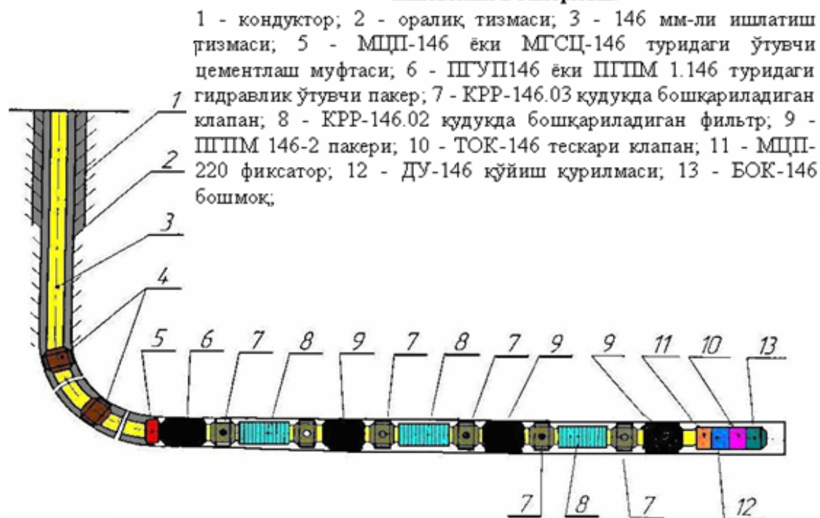
5-расм. Горизонтал қудуқ тугаллангандан кейин уни ишлатишга тайёрлаш.
