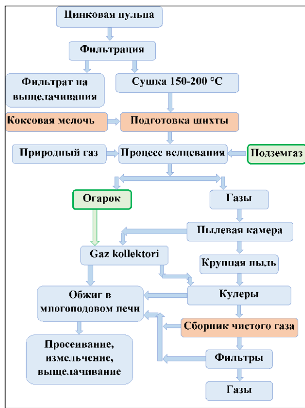
Рис. 22. Предложенная технологическая схема переработки цинкового кека с использованием восстановительных газов
