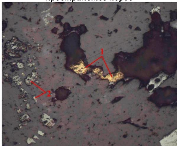
**Рис. 10.** Аншлиф № Обр/8. 1- самородное золото, 2-гидроксиды железа. Увел. 200<sup>x</sup>; без анализатора.
