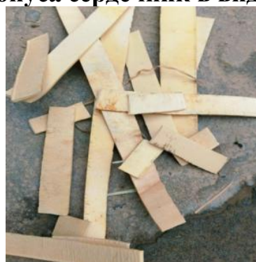
3-F-Panel - Вторичные отходы "панели", образующиеся в процессе форматирования. 4-F-ICH - Вторичные отходы, образующиеся в процессе формования.
