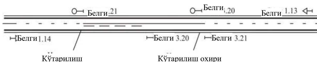
27-rasm. Tik ko'tarilish va tushish joylarida ikki polosali yo'lning belgilanishi
