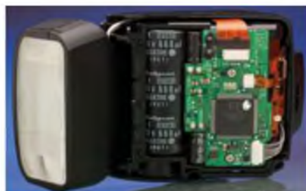
3.7-rasm. Kamera lampasi. 660 mkF dali qora kondansator
