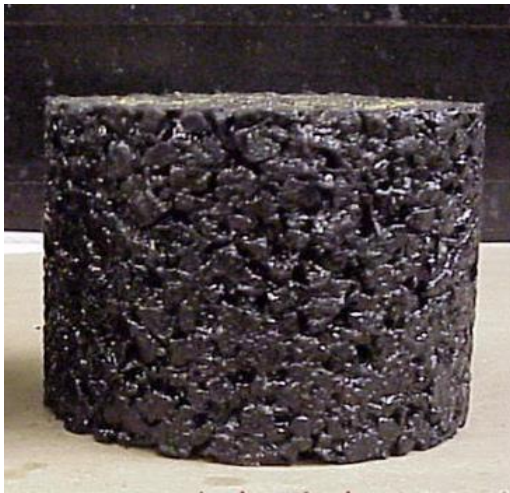
11.2-rasm. Sinov laboratoriyasida qizdirib qayta tayyorlangan namuna
