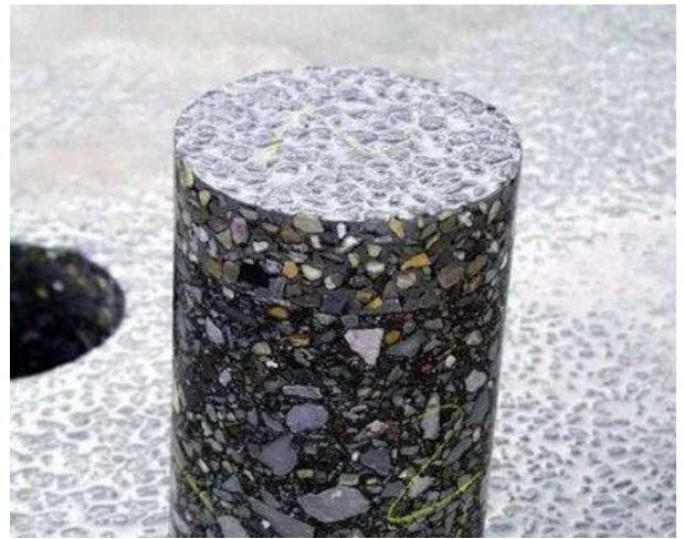
11.3-rasm. Qoplamadan kesib olingan buzilmagan namuna
