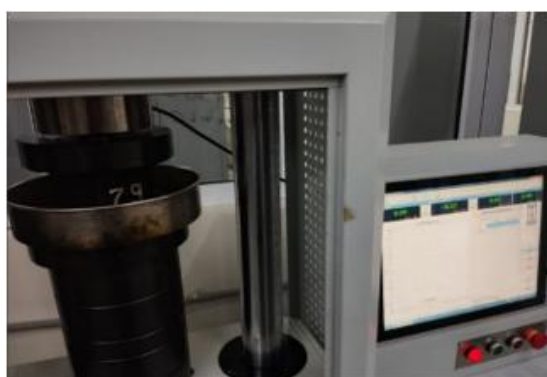
3.11-rasm. Asfaltbeton qoplamaning siqilishdagi mustahkamlik chegarasini aniqlash jarayoni.
