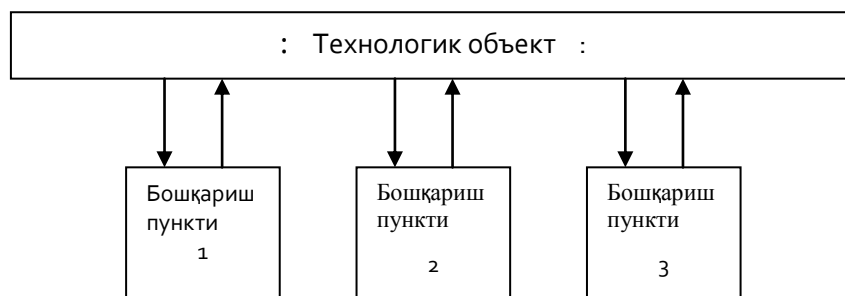
2-rasm. Avtomatlashtirish sistemasining markazlashtirilmagan bir pog'onali boshqarish sxemasi.
