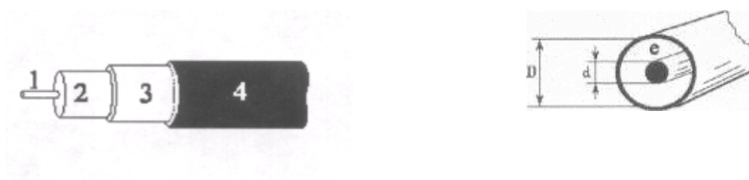
3.17-rasm. Koaksial kabelning tuzilishi.
