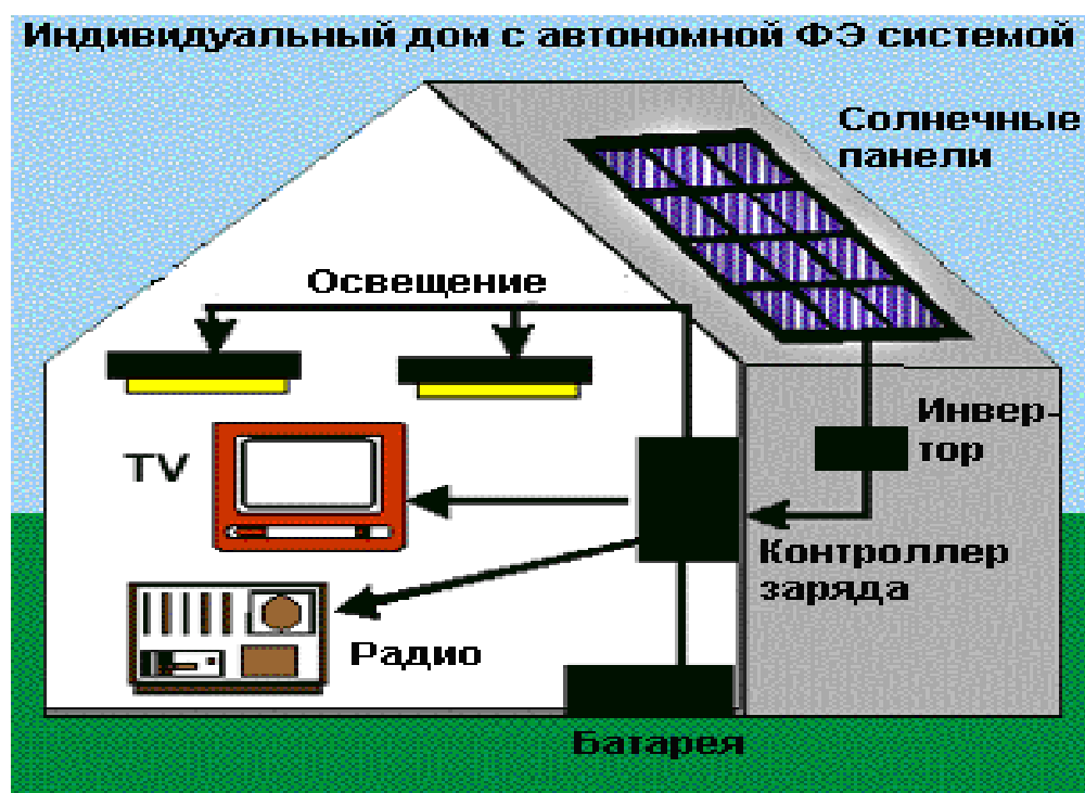
2.8 расм. Инверторли автоном фотоэлектрик системанинг уйдаги схемаси.
